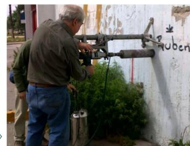
Testigos de Hormigón – Ensayo a Rotura\*
