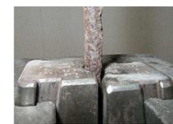
Testigo de Acero - Ensayo a Rotura\*
